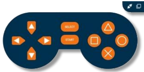
Εικόνα 3: Το εικονικό τηλεχειριστήριο της εφαρμογής Dabble για έλεγχο του κινητήρα μέσω Bluetooth.
